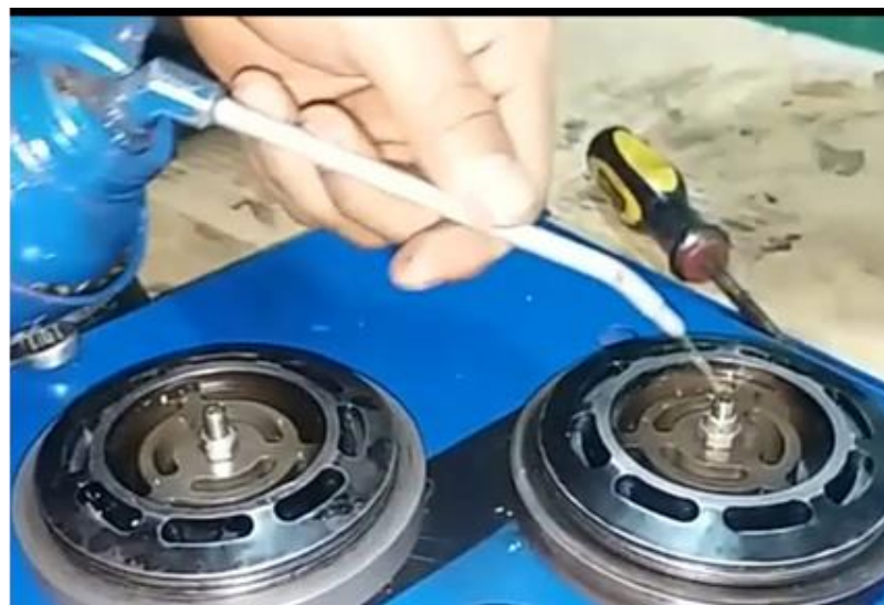
Gambar 3. suction valve dan delivery valve setelah penyekuran
