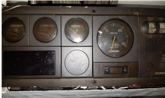
Gambar 4. Pengukur suhu mesin induk di KMP. Trisila Bhakti I
