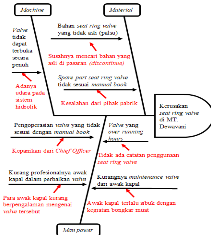
Gambar 5. Diagram fishbone faktor penyebab kerusakan seat ring valve
