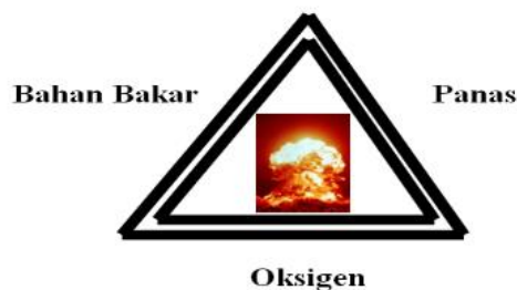
Gambar 3.5 Segitiga yang saling berkaitan untuk dapat membentuk api atau kebakaran di atas kapal
