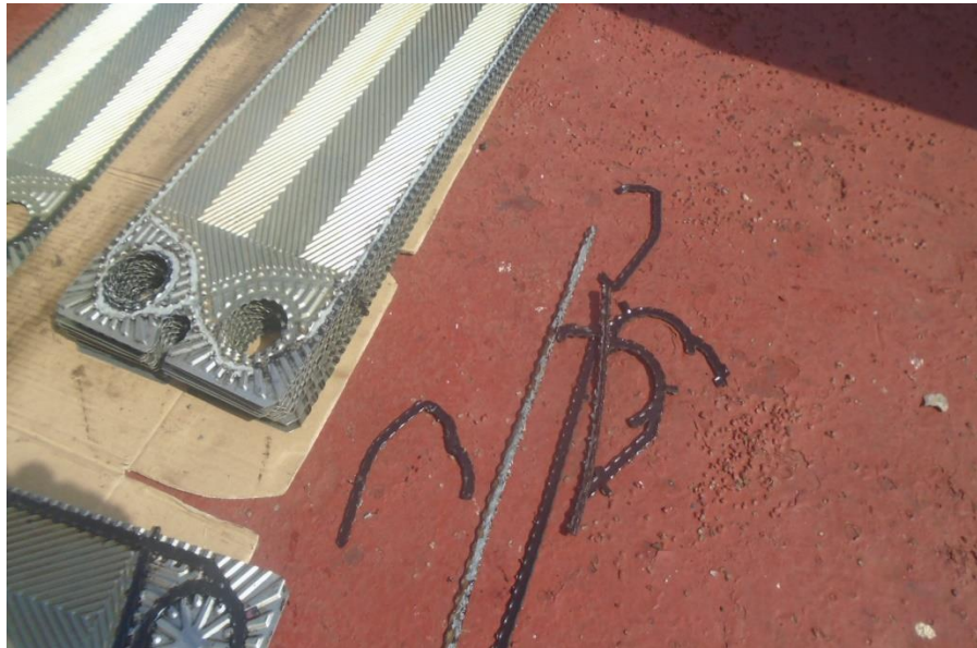
Gambar 4. Serpihan Sealant pada plate cooler (Sumber MV. Great Venture)
