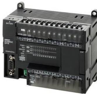
Gambar 2. PLC Omron tipe CP1E
