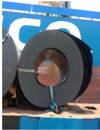
Gambar 4. Kerusakan Besi Koil Akibat Bergesekan dengan Palka Kapal
