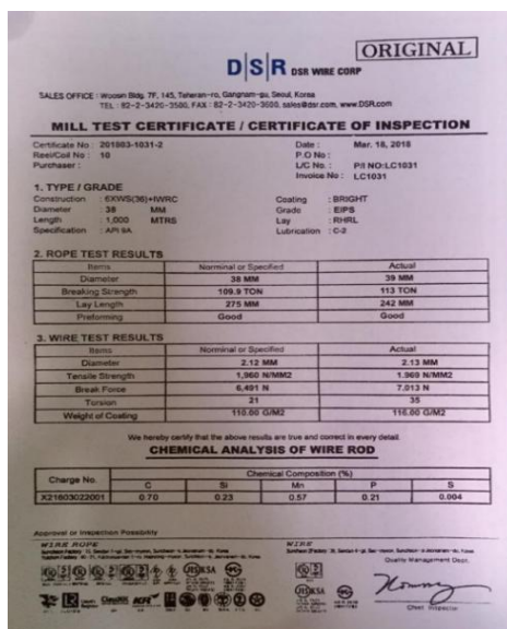
Gambar 1. Sertifikat wire sling ukuran 38 milimeter.
