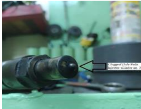
Gambar 4. Clogged hole yang terjadi pada injector silinder no 3
