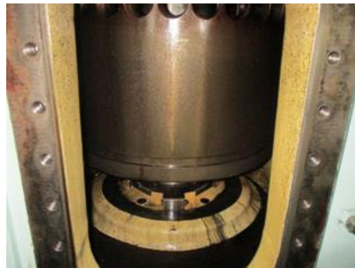
Gambar 6. Inspeksi pada piston ring
