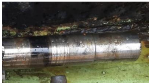
Gambar 6. Kondisi shaft setelah dilakukan pembubutan
