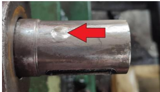
Gambar 4. Keretakan pada shaft kopling
